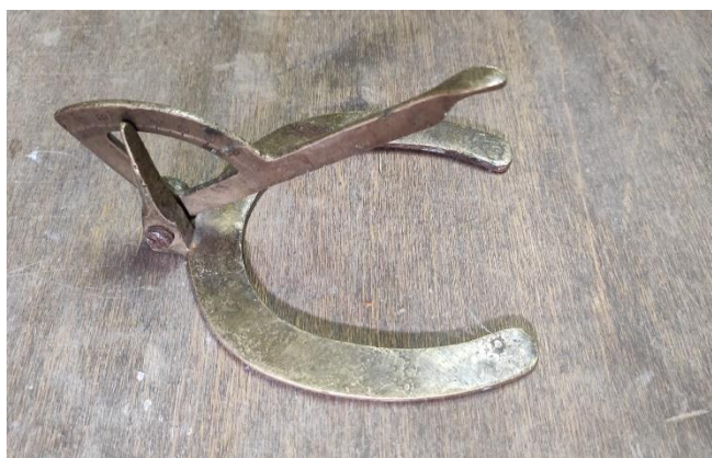
Podogoniometro, serve per misurare l'angolazione dell'unghia
