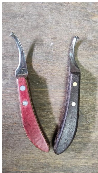
Coltellini destro e sinistro, servono per pulire e svuotare la suola dello zoccolo prima del taglio
