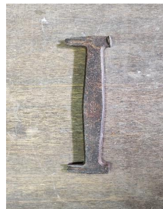
Incassino, serve per creare un incavo nella parete dello zoccolo dove alloggerà il chiodo
