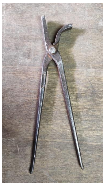
Tirachiodi per fissare definitivamente il chiodo alla parete dell'unghia
